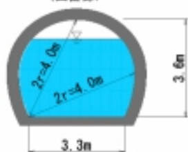
開水路トンネル (山岳部)
