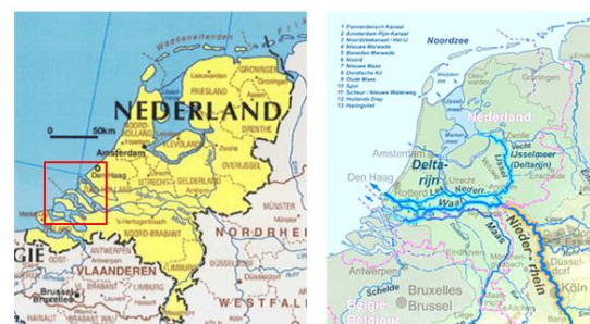
●ライン川、マース川、スヘルデ川が運ぶ土砂でできた河口の島々を堤防でつなぎ、水を排水して、干拓地(ポルダー)として利用している。
